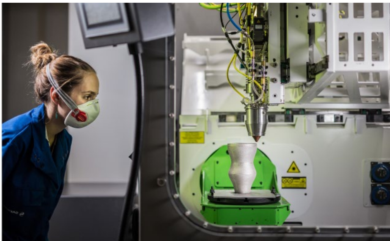
Safran - Fabrication additive déposition métallique par laser-LMD, PHOTO Adrien Daste-Safran
