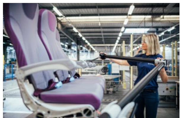
Contrôle qualité dimensionnel grâce au bras de mesure Romer sur la ligne d'assemblage finale, Cyril Abad / CAPA Pictures / Safran
