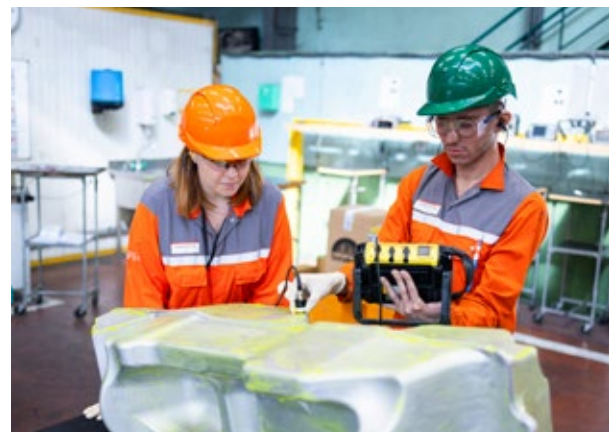
Contrôleur CND niveau 1 formant une contrôlease nouvellement arrivée sur une pièce aéro © Aubert & Duval/C.ABAD
