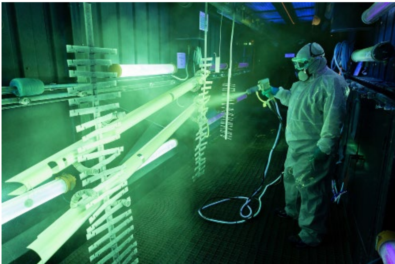
Dassault Aviation - Cabine de ressuage © Dassault Aviation/A.Février
