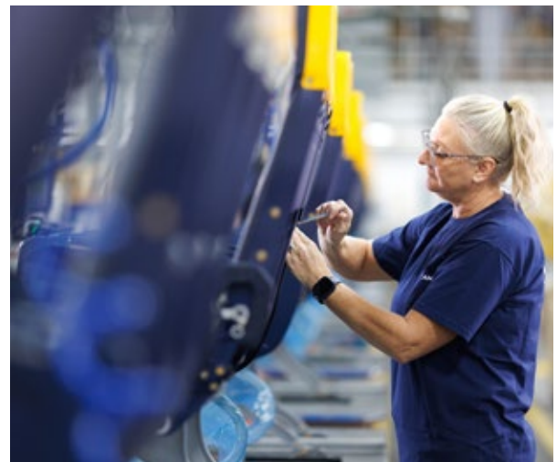
Assemblage final, sièges de classe économie Z110i, Alex Marc / Safran
