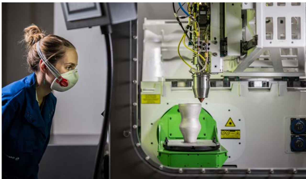
Safran - Fabrication additive déposition métallique par laser-LMD © Adrien Daste/Safran
